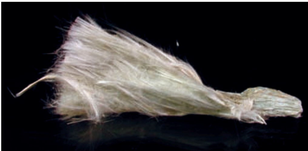
Tanki vlaknati kristali hrizotilnega azbesta. Dolžina posameznih vlaken je do 76 mm. Najdba in zbirka Vilija Podgorška. Foto: Miha Jeršek
