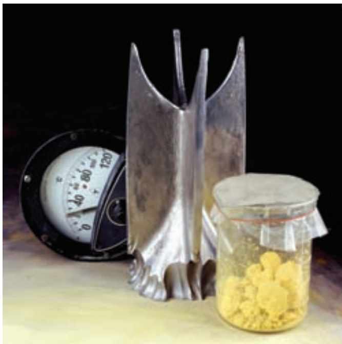
Zadnji uranov koncentrat, rumena pogača, v družbi z odsluženim ventilom di-afragemske črpalke in instrumentom iz predelovalnega obrata Rudnika urana Žirovski vrh. Foto Tomaž Lunder
