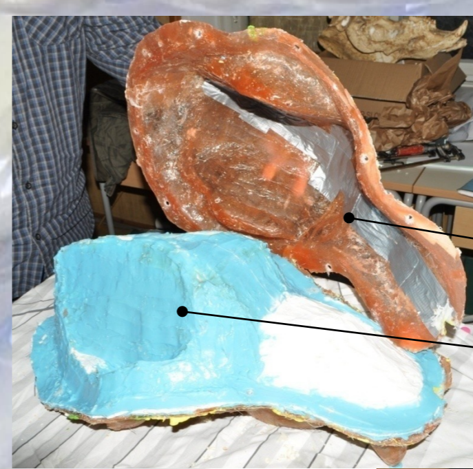
Po končni obdelavi in premazovanjem s silikonskim kavčukom smo izdelali kapo (utrjeni del kalupa). Kapa je bila izdelana iz poliestrske smole s katero smo premazali steklena vlakna (za trdnost in odpornost kalupa).
