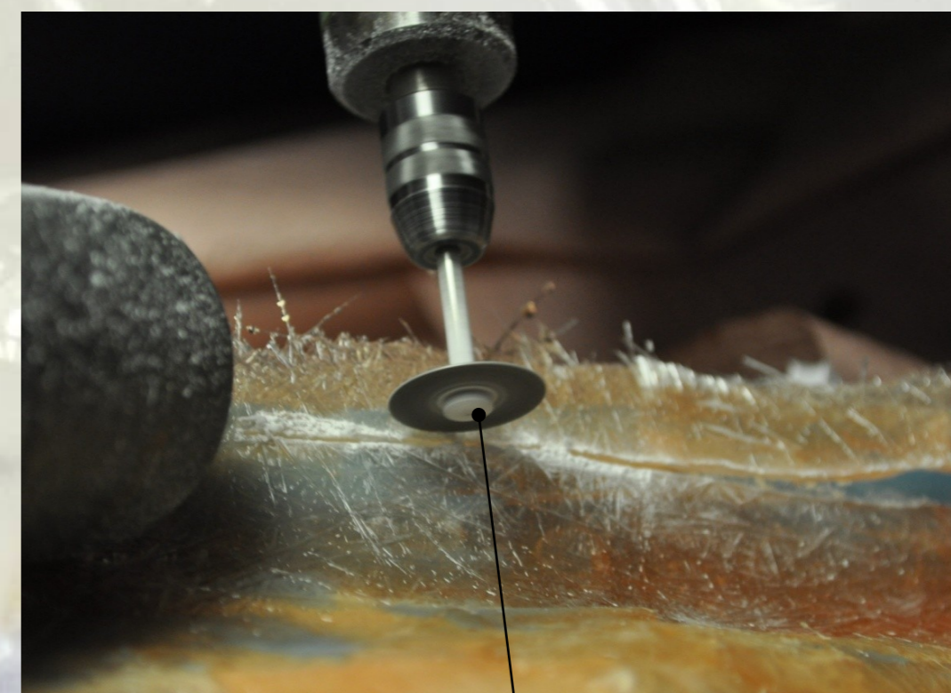
Posamezne (odvečne) dele kape smo odrezali z ročnim orodjem.
