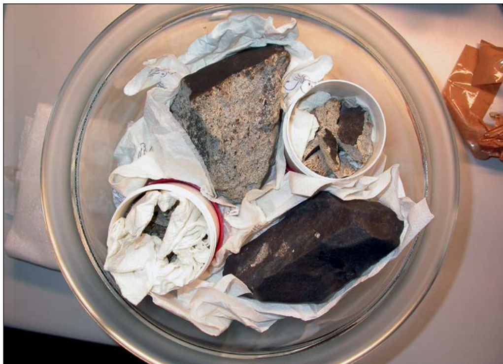
Slika 92. Zaradi vlage in kisika v ozračju so minerali v meteoritu Jesenice začeli preperevati. Za potrebe znanstvenih raziskav so bili shranjeni v vakuumu. Na sliki so kosi prvega in tretjega fragmenta meteorita Jesenice. Foto: Miha Jeršek
