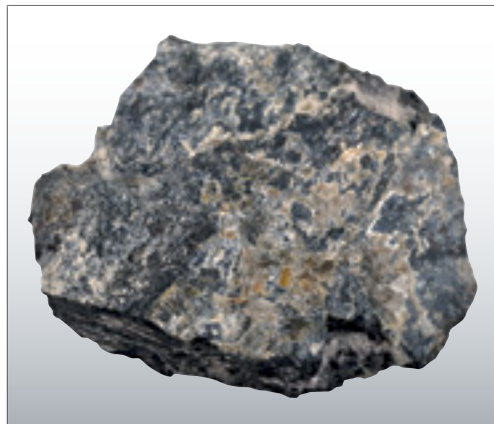
Hematitno psilomelanova ruda z enstatitom, rudnik manganove rude Cer pri Kičevu, Makedonija
